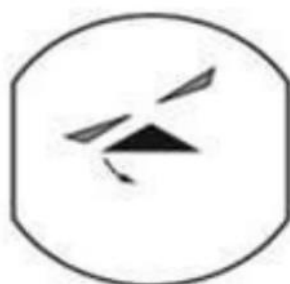
(d) Fly left command. Fly the a/c to left to satisfy command bar
